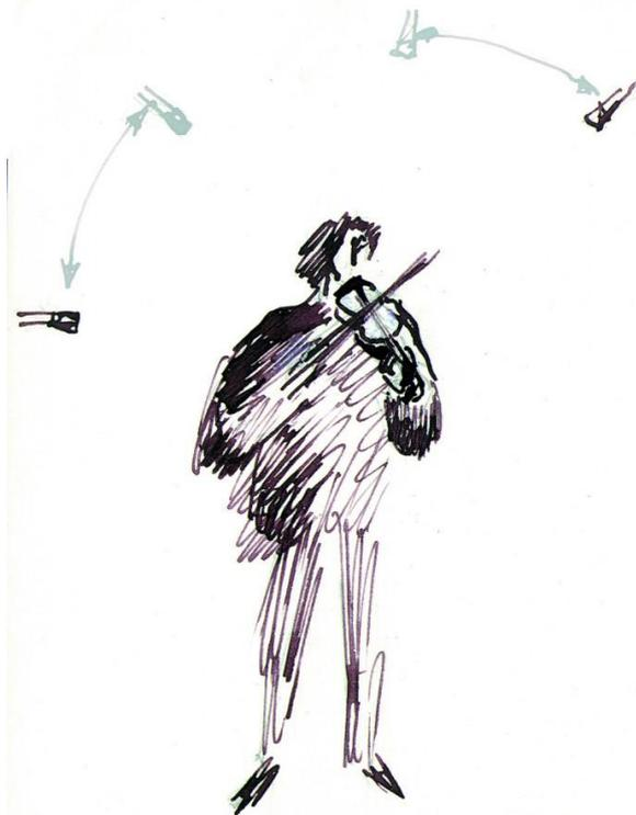
При записи сольной скрипки лучшие результаты получались, когда ставились два микрофона на расстоянии 15...20 см друг от друга и от 1,5 до 2,5 метров от инструмента. Микрофоны по высоте должны быть на уровне самого инструмента или чуть выше. Поднимая микрофоны еще выше и "навешивая" над инструментом ближе к оси направленности звука, можно получить более насыщенное обертонами и призвуками звучание. Звук у хорошего инструмента становится более ярким звонким. У инструмента
